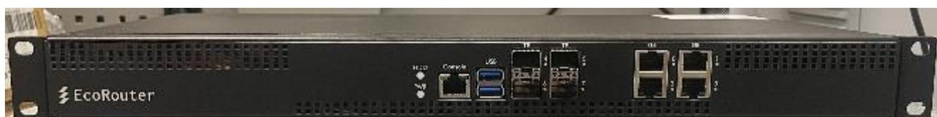
Рисунок 6 – Оборудование коммутации и маршрутизации пакетов информации сетей передачи данных EcoRouter. Модификация ER-T406. Лицевая панель
