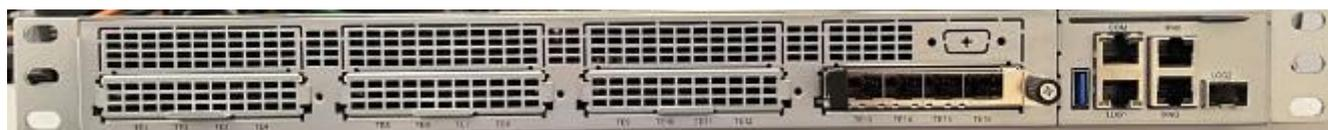
Рисунок 7 – Оборудование коммутации и маршрутизации пакетов информации сетей передачи данных EcoRouter. Модификация ER-T1004. Лицевая панель
