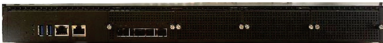
Рисунок 3 – Оборудование коммутации и маршрутизации пакетов информации сетей передачи данных EcoRouter. Модификация ER-1004 S. Лицевая панель
